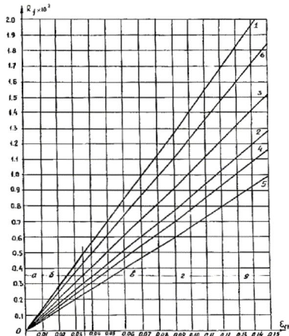
**Рис. 2.1** . Зависимость относительной деформации пучения  $e_{пн}$  от параметра  $R_f$
