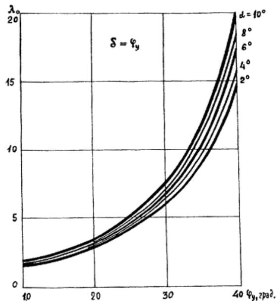
**Рис. 2.** Графики для определения коэффициента  $\lambda_0$  для песчаных грунтов в зависимости от угла внутреннего трения грунта  $j_y$  и угла наклона к вертикали надвигающейся на грунт грани  $\alpha$  при угле трения грунта о бетонную поверхность  $d = j_y$
