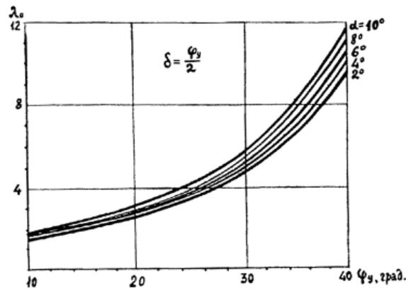
**Рис. 3** . Графики для определения коэффициента  $\lambda_0$  для глинистых грунтов и зависимости от угла внутреннего трения грунта  $j_y$  и угла наклона к вертикали надвигающейся на грунт грани  $\alpha$  при угле трения грунта о бетонную поверхность  $\delta = 0,5j_y$ .
