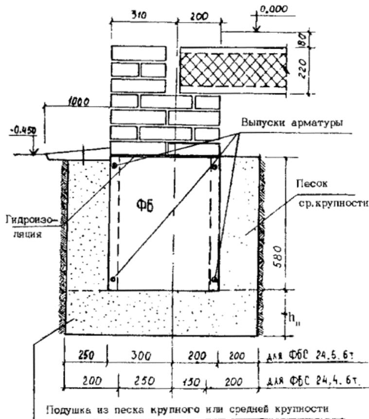
Рис. 4 . Вариант мелкозаглубленного фундамента под кирпичный дом при грунтах с  $e_{fh} \geq 0,10$ .
