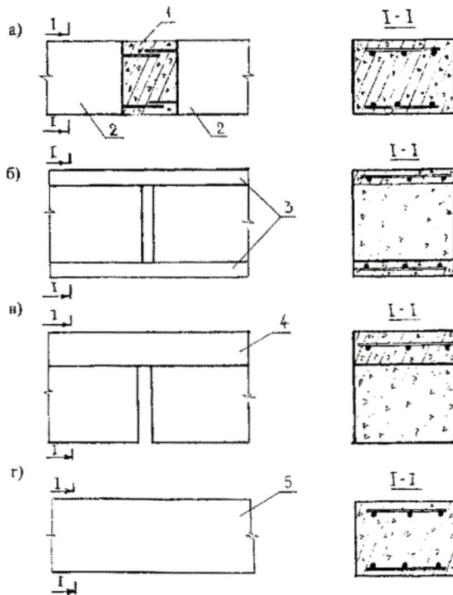
Рис. 1. Конструктивные решения соединений элементов мелкозаглубленных ленточных фундаментов:
