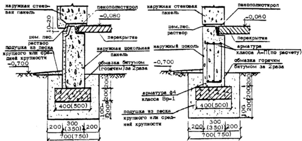
Рис. 3 . Вариант мелкозаглубленного фундамента из сборных элементов
