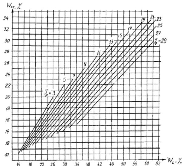
**Рис. 2.2** . Зависимость критической влажности  $W_{кр}$  числа пластичности  $J_p$  и предела текучести грунта  $W_L$
