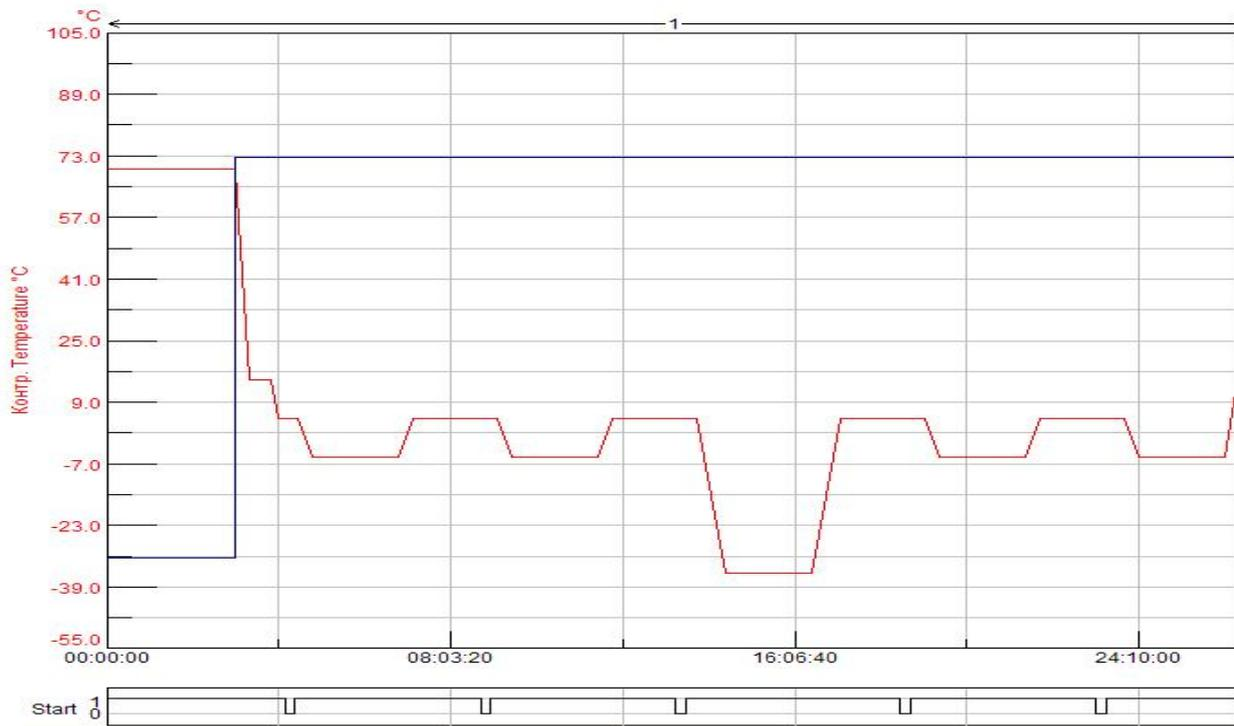
Рисунок А.1 – Графическая модель 1 цикла климатических испытаний
